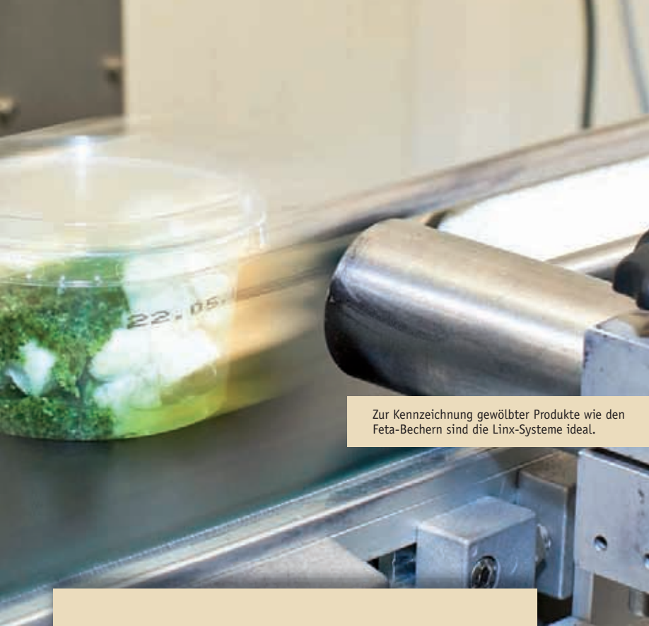
Bis zu 30 Becher pro Minute werden von oben und unten etikettiert.
