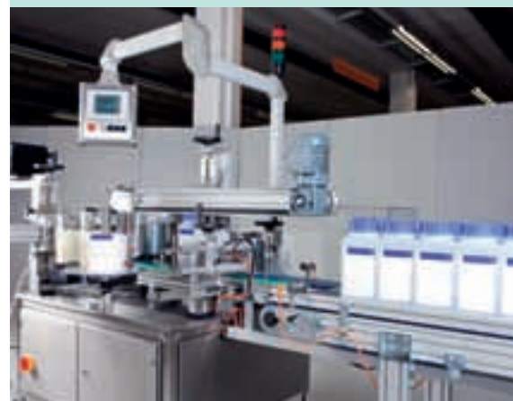
Die Anlage ist so konstruiert, dass runde, eckige und schwergewichtige Verpackungen etikettiert werden können.
