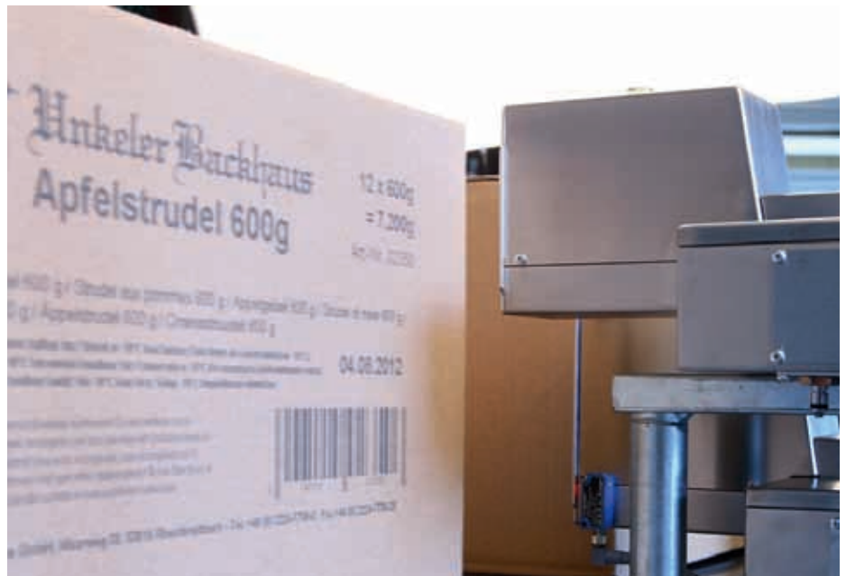
Der Multiline MX beschriftet Produkte hochauflösend mit Texten, Barcodes und Grafiken in Höhen von 50, 100, 150 oder gar 200 mm.
