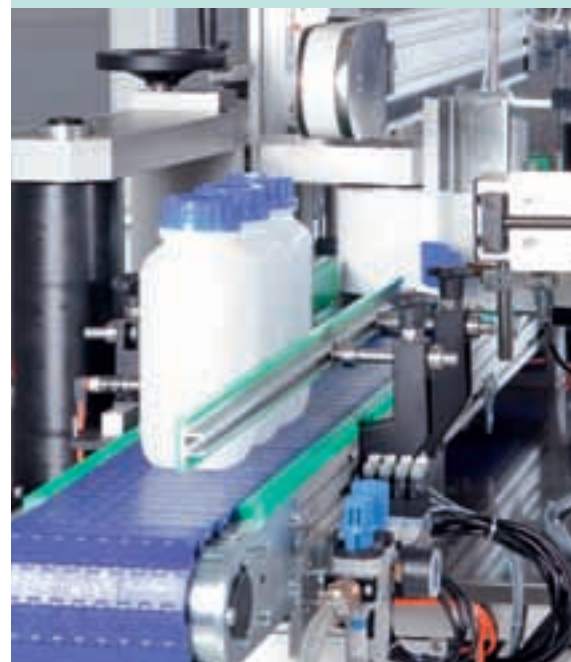
Die Anlage ist so konstruiert, dass runde, eckige und schwergewichtige Verpackungen etikettiert werden können.
