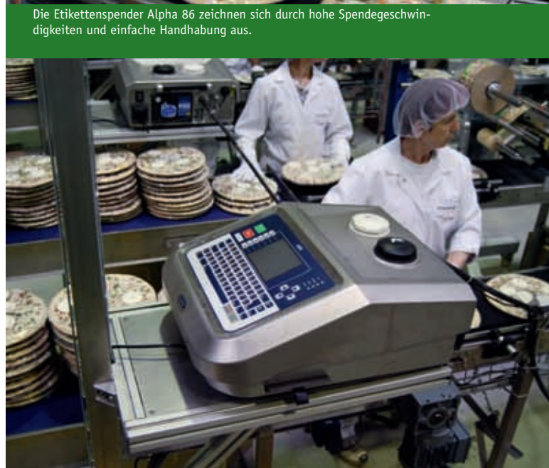
Mit abgerundetem, leicht zu reinigenden Edelstahlgehäuse und IP 65-Schutz ist der Linx-Codierer ideal für den Einsatz in der Lebensmittelbranche.
