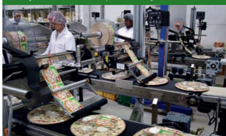
Die Etikettenspender Alpha 86 zeichnen sich durch hohe Spendegeschwindigkeiten und einfache Handhabung aus.
