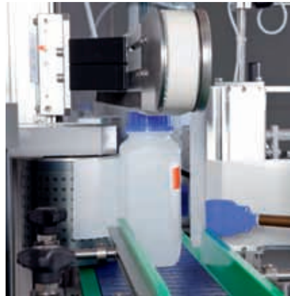
Die Etiketten werden mittels einer Saugtrommel auf die Flaschen aufgebracht.
