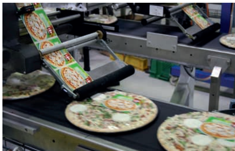
Die vorgedruckten Etiketten werden im Wipe-On-Verfahren aufgebracht.
